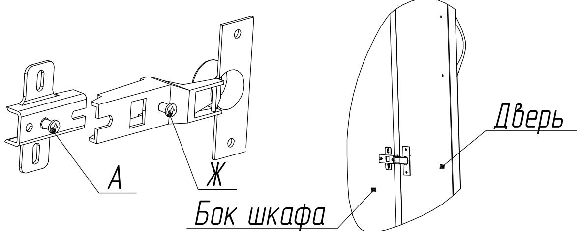
**Горизонтальное положение двери и зазоры отрегулировать винтом Ж.
