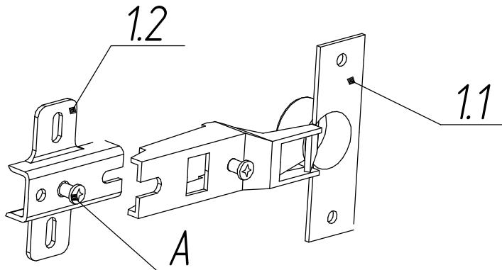
2. В дверь в отверстия диаметром 35 мм установите петлю 1.1 и прикрутите ее шурупами US 3.5x16 поз. 4 по намеченным отверстиям. (2 шурупа на одну петлю).
