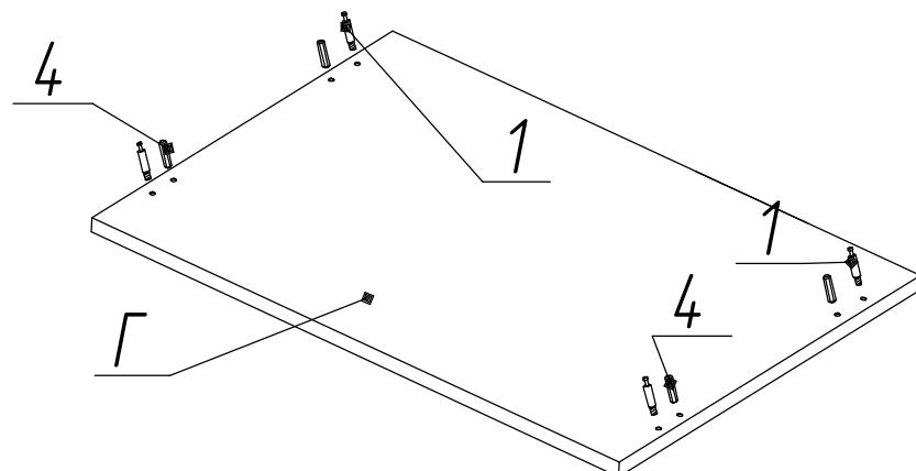
4. В дно тумбы поз. Д на расстоянии примерно 15 мм. от краев с наружной стороны с помощью молотка вбить опоры с гвоздем поз. 9.
