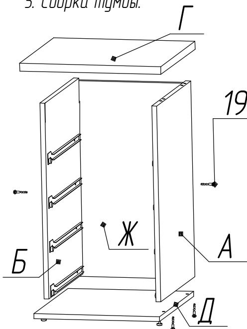
Собрать стенки боковые поз.А и Б, стенку заднюю Ж скрепить их винтами конфирмат поз.19.
